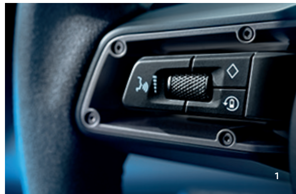
1 Кнопка зміни режимів рекуперації на рульовому колесі
